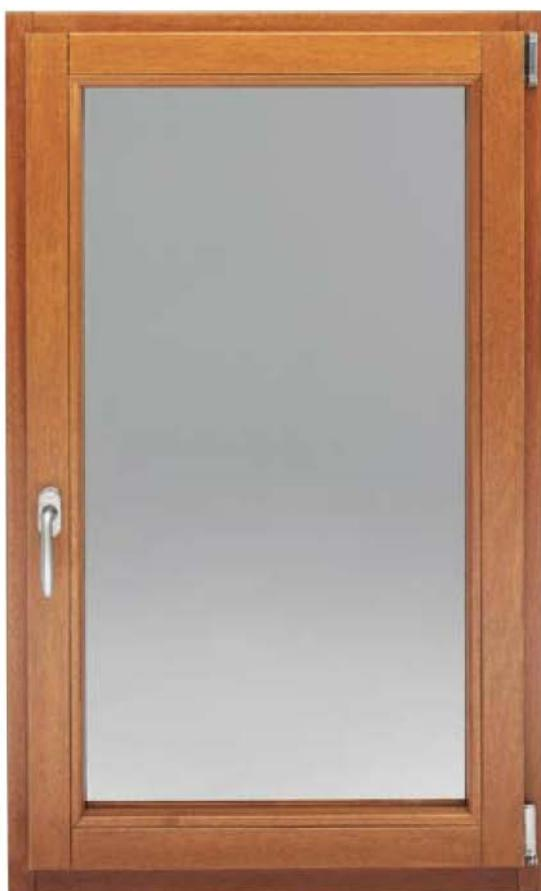
La LINEA CASA TOP è tra i serramenti con le migliori prestazioni di isolamento termico e acustico che si possano reperire oggi sul mercato. Questo grazie allo spessore del profilo del battente (anta) di ben 92 mm che può alloggiare vetri basso emissivi magnetronici con doppia camera, stratificati sia all'interno che all'esterno, con prestazioni tecniche determinanti.
