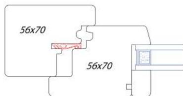
*Finestra in pino tinto noce scuro, apertura ad anta/ribalta, martellina finitura cromo satinata, cappucci copri cerniera in pvc finitura cromo satinata. Particolare apertura ad anta/ribalta. Nodo laterale profili telaio fisso (cassa) 56x70 mm, battente (anta) 56x70 mm.*
