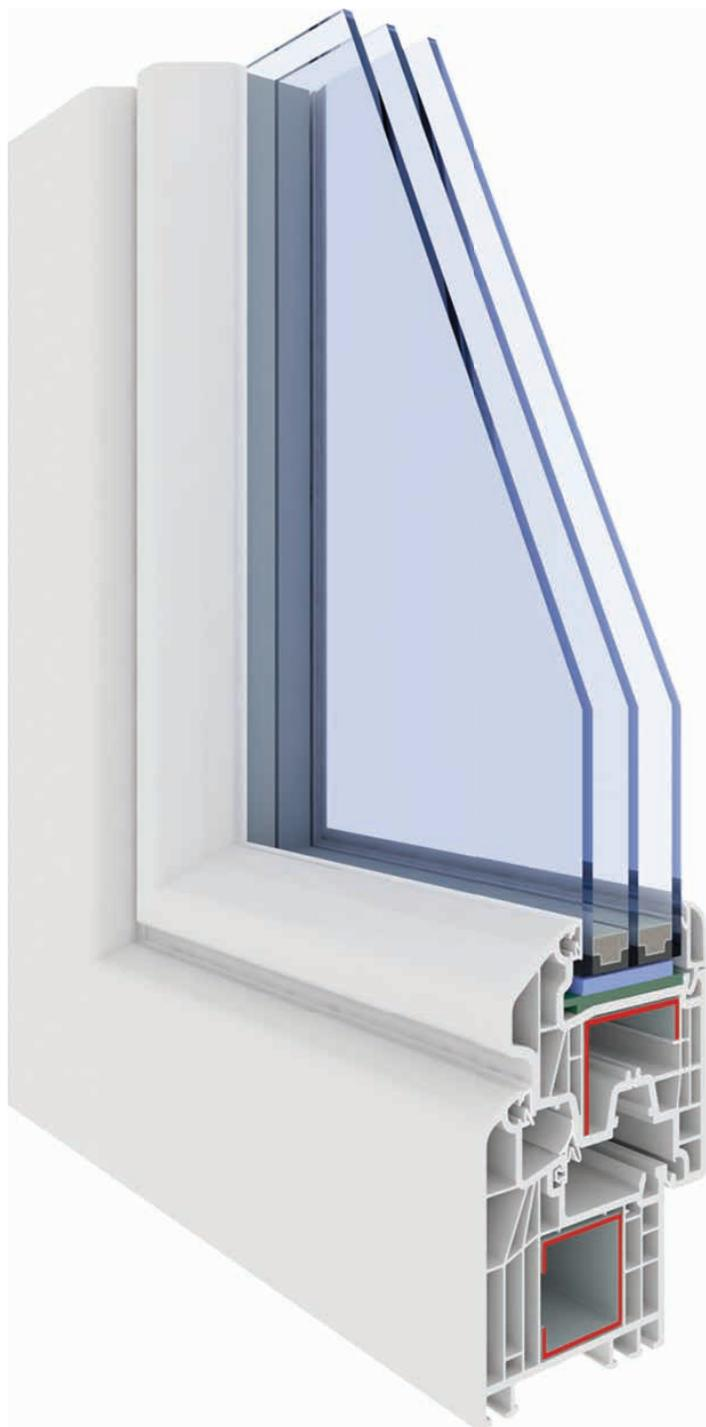
Il sistema a giunto aperto è realizzato con profili in classe A e mescola S a 6 e 7 camere su telaio e anta con rinforzi in acciaio zincato.
